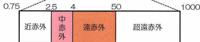
アクア遮ネックスは**熱に変換される赤外線**の波長を効率的に反射させる遮熱顔料を採用しているため、赤外線を吸収する従来の塗料と比較した場合、屋根材の温度上昇を抑制する機能に優れています。
