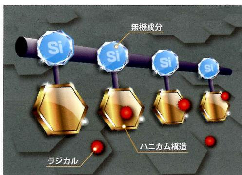
樹脂骨格にハニカム構造と無機成分（ポリシロキサン）を配合した無機系ハニカムレジンを採用することで、塗膜の耐水性や強度が増し、フッ素樹脂の性能を補佐します。
