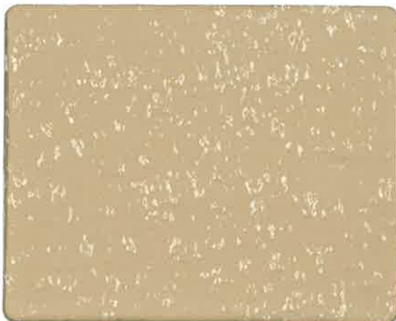
ゆず肌状仕上げ（吹付け）
